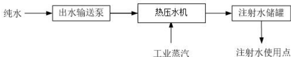
图 2-2 注射水制备工艺流程图
